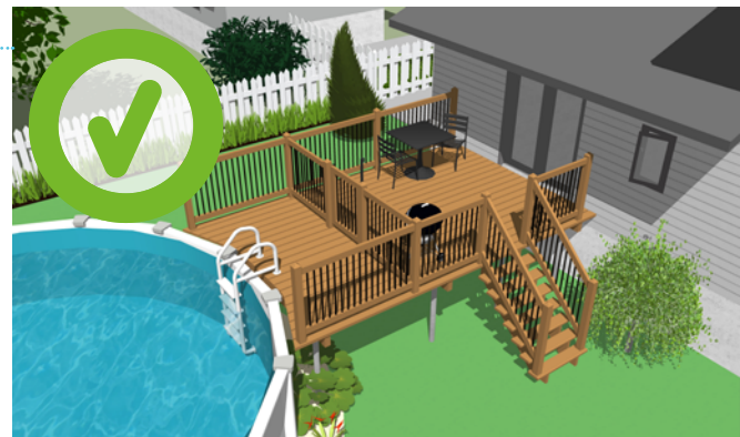
Exemple de terrasse rattachant la piscine à la résidence. La partie ouvrant sur la piscine est adéquatement protégée par une enceinte.
